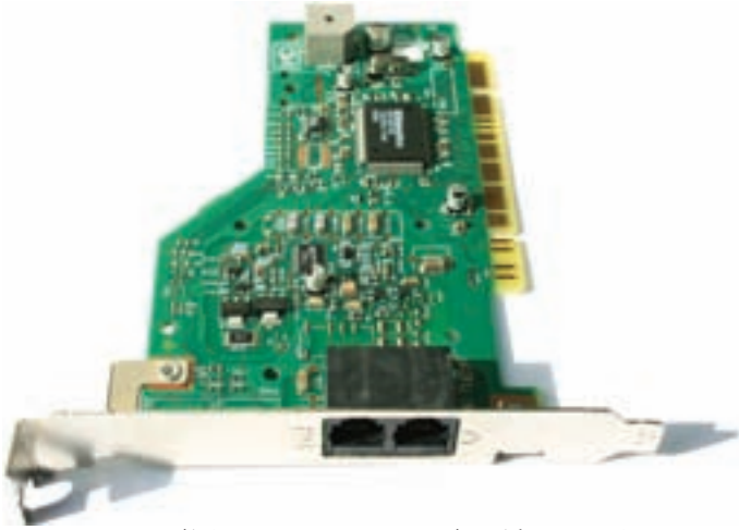
شکل ۲۹-۵ کارت فکس مودم برای نصب در شکاف PCI
