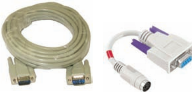
شکل ۵-۱۶ تبدیل رابط ۹ پین به رابط S-Video (سمت راست) و رابط D-SUB (سمت چپ)
