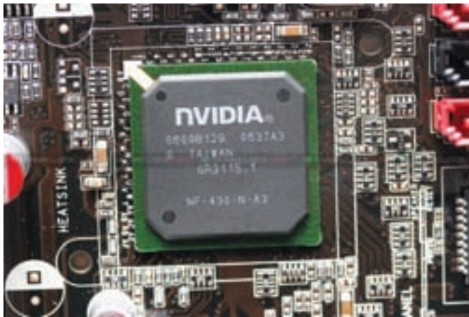
شکل ۲-۵ مدار واسط گرافیکی که به صورت سرخود روی برد اصلی وجود دارد
