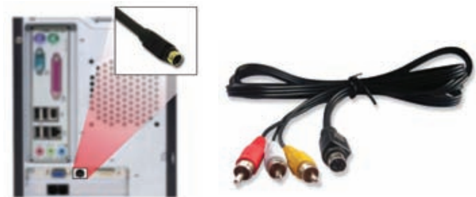
شکل ۵-۱۱ کانکتور (S-Video) به رنگ مشکی و کانکتورهای رنگی دیگر، جهت اتصال به تلویزیون
