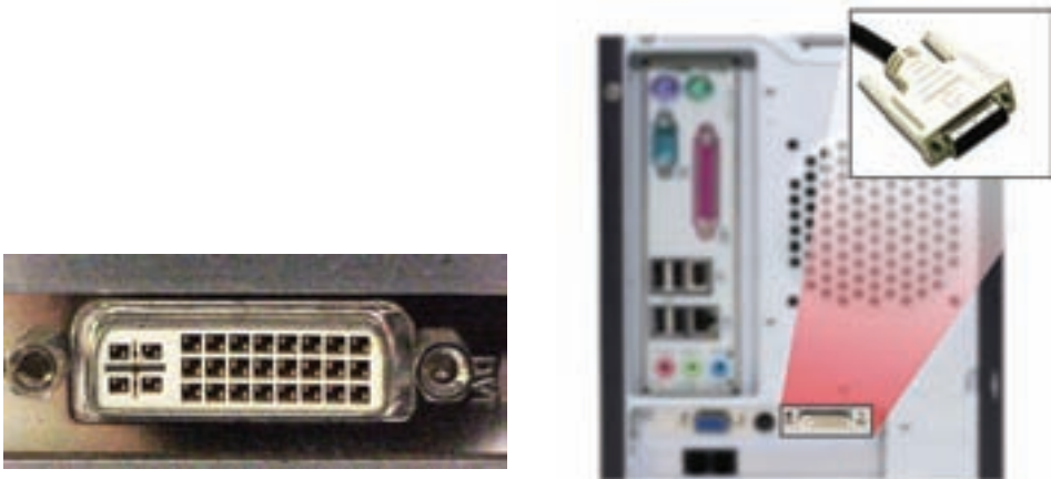
شکل ۵-۱۷ درگاه DVI برای اتصال به صفحه‌نمایش‌های دیجیتال
