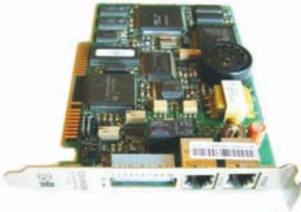
شکل ۳۰-۵ کارت فکس مودم برای نصب در شکاف ISA
