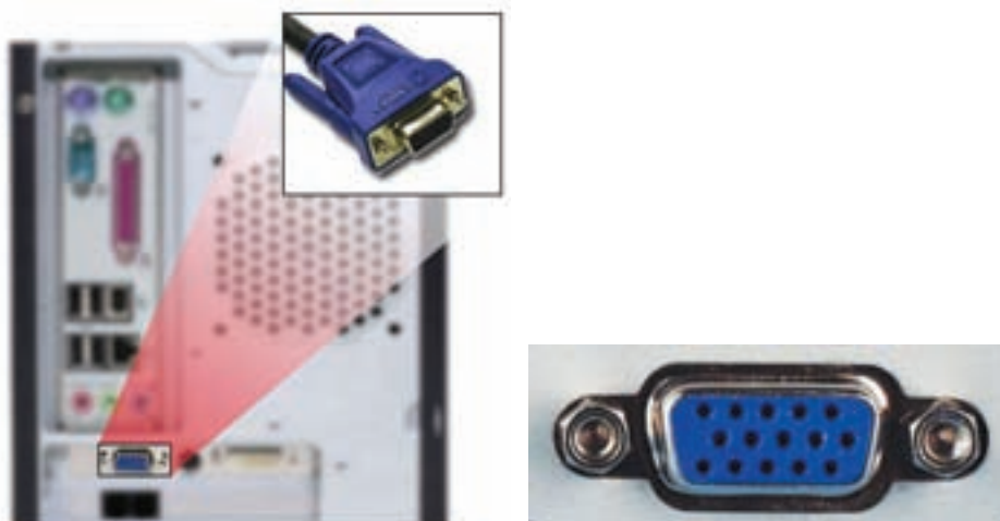
شکل ۱۵-۵ درگاه خروجی ۱۵ پین VGA برای اتصال به صفحه‌نمایش‌های آنالوگ
