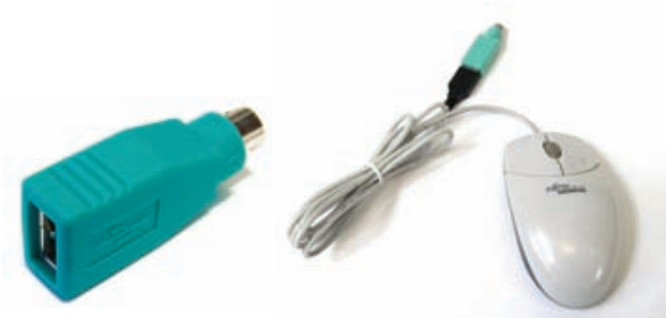
شکل ۲۹-۶ تبدیل USB به رابط PS/2 برای ماوس
