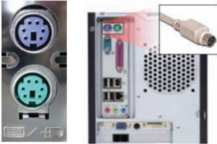
شکل ۶-۲۴ محل اتصال رابط‌های PS/2 صفحه‌کلید (رنگ بنفش) و ماوس (رنگ سبز)
