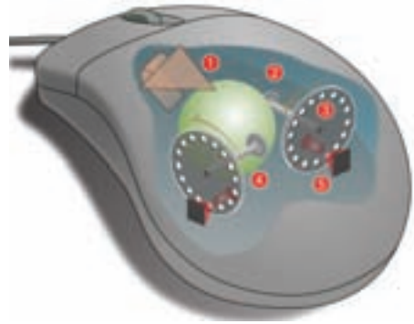
شکل ۲۷-۶ درون ماوس مکانیکی - نوری
