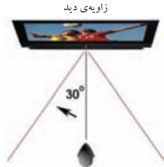
شکل ۸-۶ بهترین کیفیت تصویر برای این LCD، از دید عمود کاربر و تا زاویه‌ی ۳۰ درجه
