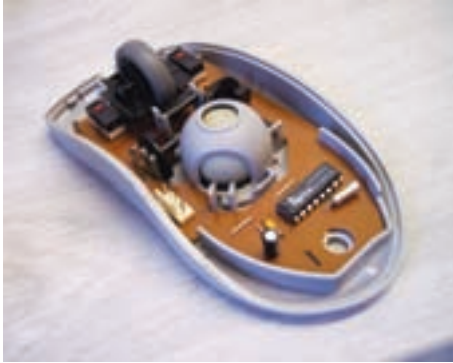
شکل ۲۷-۶ درون ماوس مکانیکی - نوری
