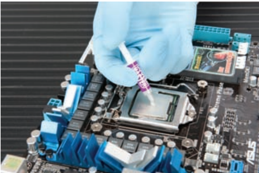
شکل ۸-۷ پوشاندن پردازنده با خمیر انتقال حرارت
