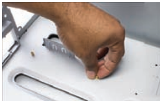
شکل ۸-۱۲ ثابت کردن پایه‌های برنجی
