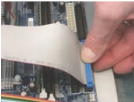
شکل ۸-۲۲ نصب کابل IDE
