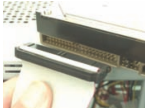
شکل ۸-۲۲ نصب کابل IDE
