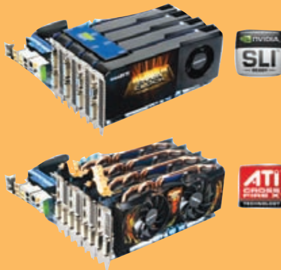
شکل ۸-۲۵ نصب کارت‌های گرافیک CrossFire و SLI
