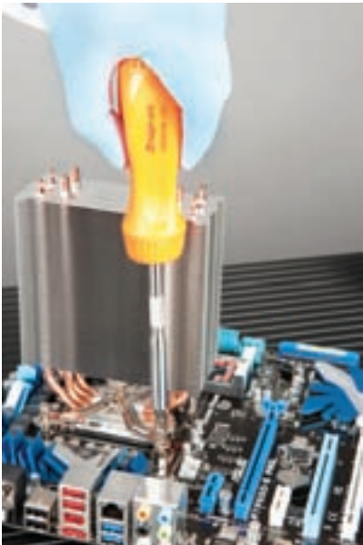
شکل ۸-۸ نمونه‌ای از نصب پایه‌ی خنک‌کننده
