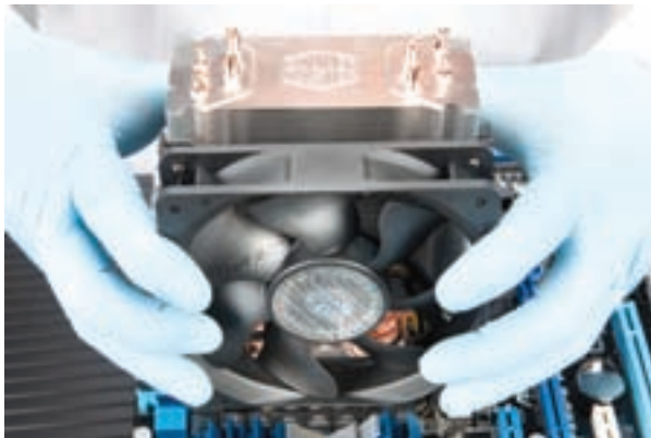
شکل ۸-۹ نصب خنک‌کننده‌ی پردازنده
