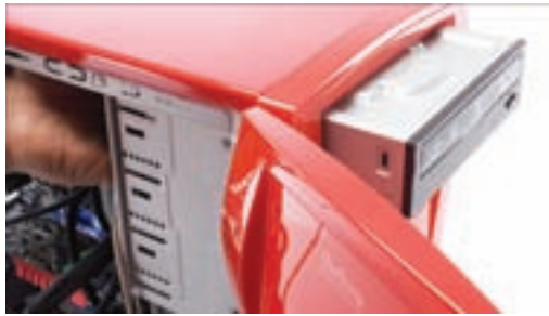
شکل ۸-۲۱ استقرار دیسک گردان نوری
