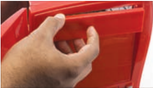
شکل ۲۰-۸ برداشتن پانل جلوی کیس
