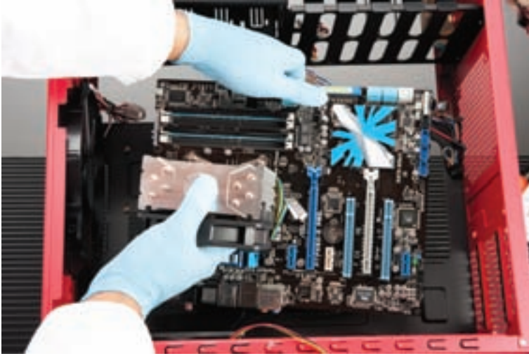
شکل ۸-۱۴ نصب برد اصلی
