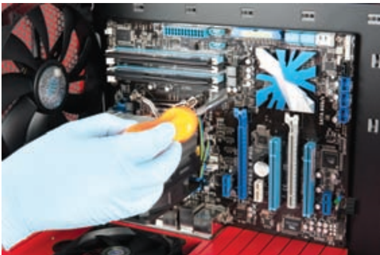
شکل ۸-۱۵ بستن پیچ‌های برد اصلی
