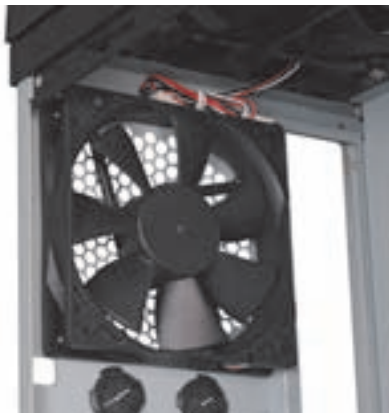
شکل ۳-۸ نصب پروانه‌ی خنک‌کننده‌ی کیس
