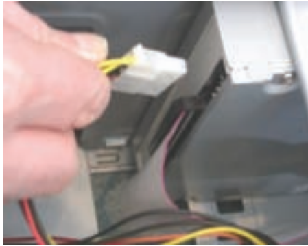
شکل ۲۳-۸ اتصال کابل برق دیسک گردان نوری
