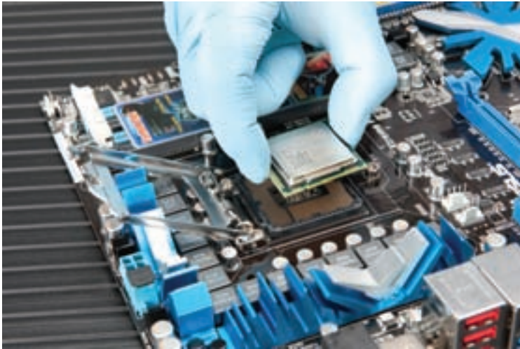
شکل ۸-۵ هماهنگ کردن فرورفتگی‌های پردازنده با برآمدگی‌های روی سوکت
