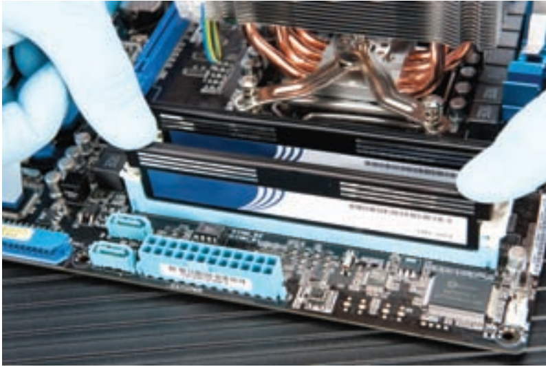
شکل ۸-۱۱ استقرار ماژول حافظه در شکاف حافظه
