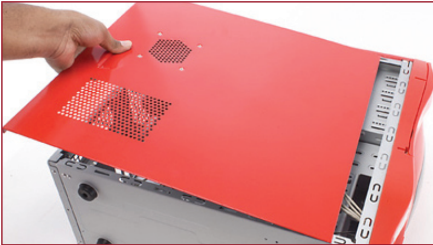
شکل ۸-۱ برداشتن قاب‌های جانبی
