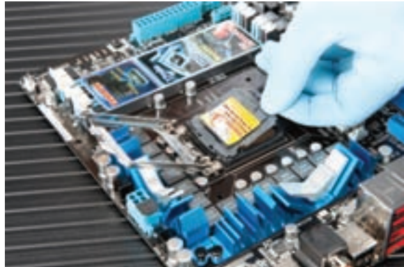
شکل ۸-۴ برداشتن پوشش محافظ سوکت پردازنده
