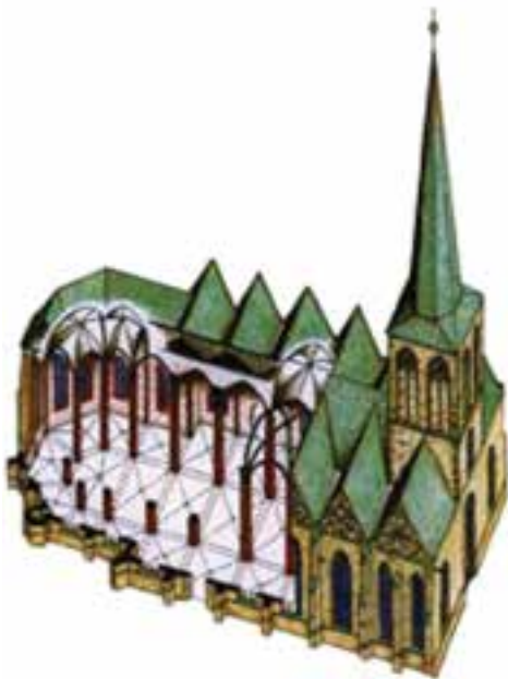
تصویر ۹ - طرح کلی یک کلیسای گوتیک
