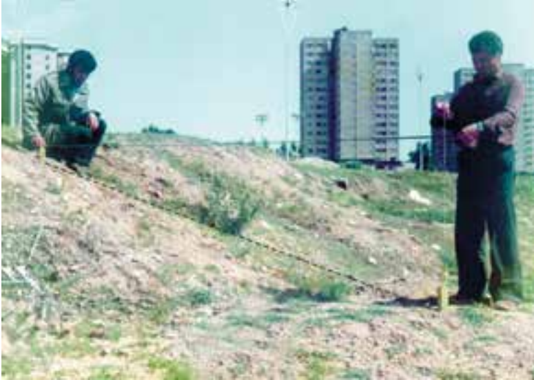
شکل ۱-۲۱- یک نمونه از کاربرد خاصیت عمود و مایل در نقشه برداری
