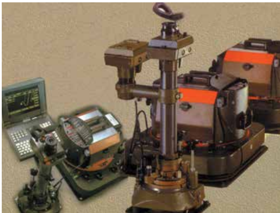
شکل ۱-۲- الف - دوربین Wild RC30 قدیمی عکس‌برداری هوایی
