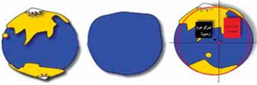
شکل ۳-۴- شکل طبیعی سطح زمین (چپ)، سطح متوسط آبهای آزاد یا ژئوئید به عنوان سطح مبنای ارتفاعی (وسط)، و بیضوی دورانی به عنوان سطح مبنای مسطحاتی (راست)
