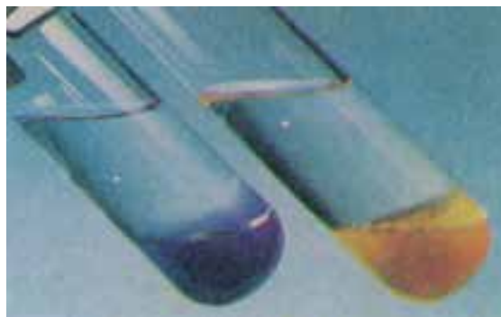
شکل ۳-۷- آزمایش تشخیص آلکن از آلکان
