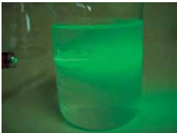
شکل ۲-۵- عبور نور از یک مایع کلوئیدی
