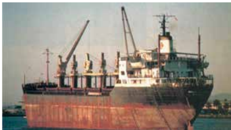
زنگ زدگی در یک کشتی
