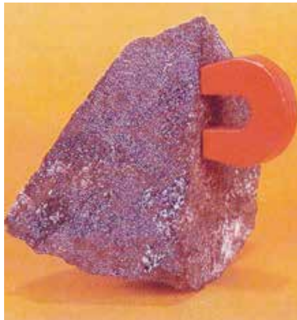
شکل ۵-۷ کاتالیزگر آمونیاک متشکل از کانی حاوی آهن‌اکسید
