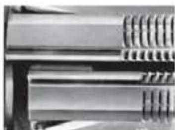
الف- صفحه سوزن پشت به اندازه سه سوزن به سمت راست حرکت داده شده است.
