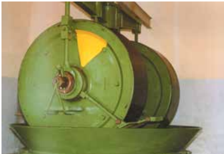
شکل ۴۵-۶- سنگ شکن جهت خرد کردن باروت
