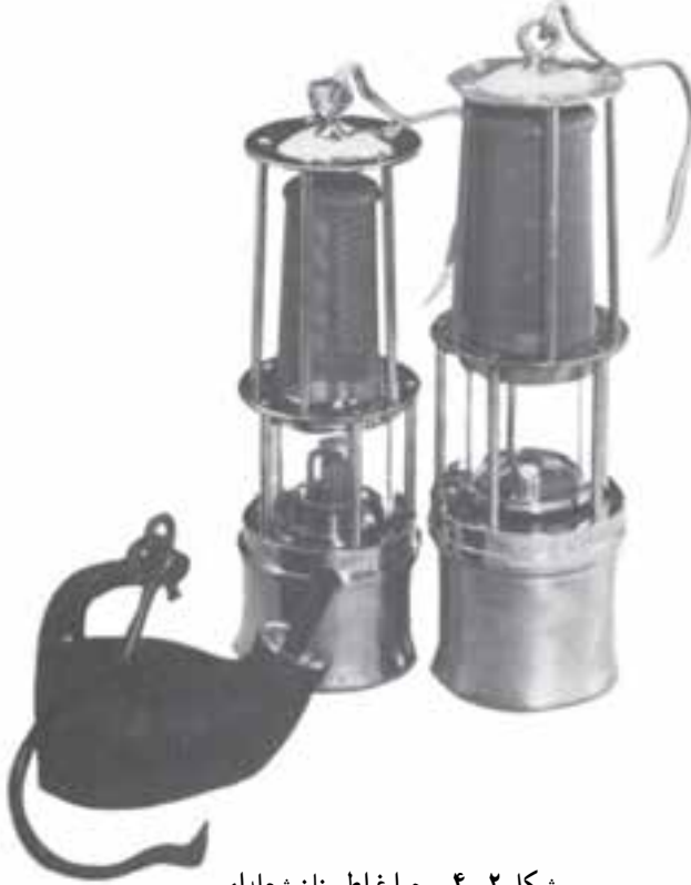
شکل ۲-۴- چراغ اطمینان شعله‌ای
