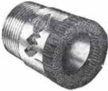
شکل ۱۵-۷- سرمته نمونه گیر الماسی
