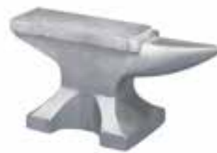
شکل ۹-۲ سندان از جنس فولاد
