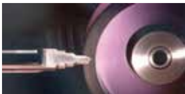
شکل ۱-۳۳ ابزار تیزکن از جنس الماس
