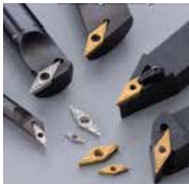
شکل ۳-۵۳ ابزارهای روکش شده با تیتانیم
