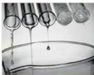
شکل ۳-۵ مقایسه ویسکوزیته چند مایع
