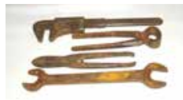
شکل ۱-۴۶ آثار خوردگی بر سطح ابزار
