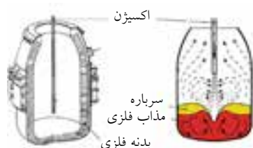
شکل ۲-۸ کوره L-D یکی از روش‌های تولید فولاد.
