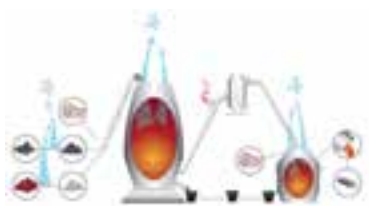
شکل ۲-۴ مراحل گوناگون تلخیص و استحصال آهن از سنگ آن
