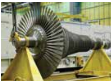
شکل ۲-۳۵ کاربرد فولادهای نسوز در تولید توربین‌های گازی
