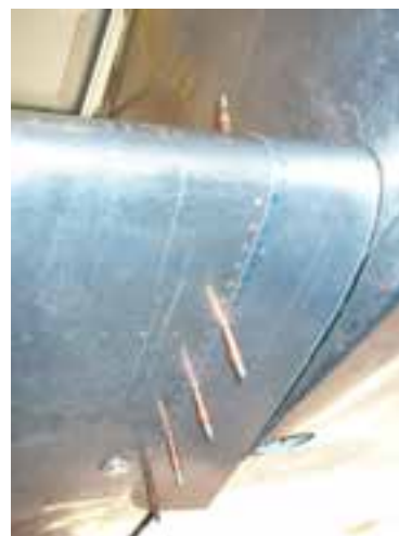
شکل ۳-۴۵ پرچکاری بال هواپیما
