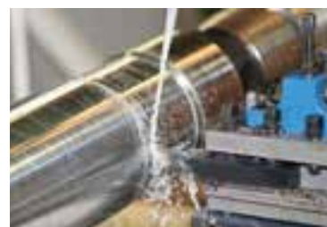
شکل ۲-۳۱ قطعه در حال تراش بدون براده برداری
