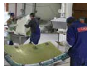
شکل ۱-۱۶ قالب‌گیری و تولید قطعات فایبرگلاس
