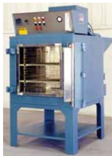
شکل ۲-۴۴ کوره عملیات حرارتی آزمایشگاهی
