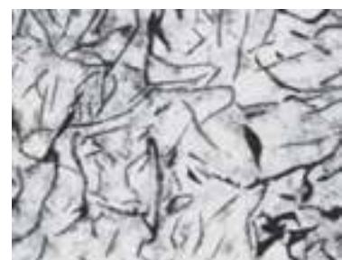
شکل ۲-۴۹ چدن خاکستری با گرافیت ورقه‌ای
