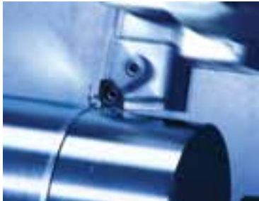
شکل ۳۸-۱ به دلیل سختی کاربردها از آن‌ها برای براده‌برداری از فلزات استفاده می‌شود.
