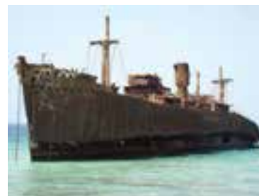
شکل ۲-۱ اثر خوردگی در بدنه فولادی کشتی یونانی در جزیره کیش به وضوح قابل مشاهده است.
