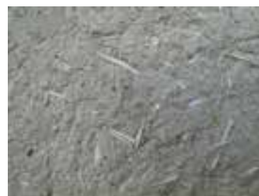
شکل ۱-۱۵ کاه گل شاید یکی از اولین انواع کامپوزیت‌ها باشد
