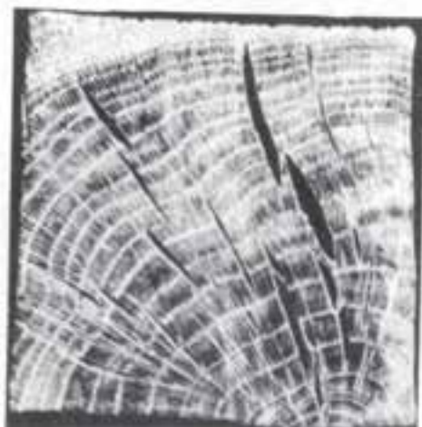
شکل ۲۱-۱- شانه عسلی شدن مقطع یک قطعه چوب بلوط
