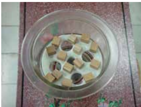
شکل ۱-۷- نمونه‌های آزمون رطوبت در داخل دسیکاتور
