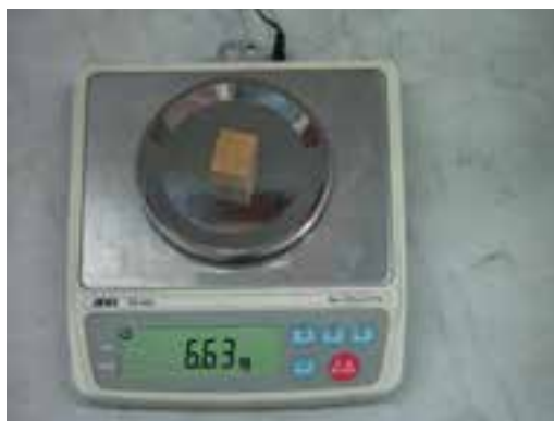
شکل ۱-۵- ترازوی دقیق و نحوه توزین نمونه چوب
