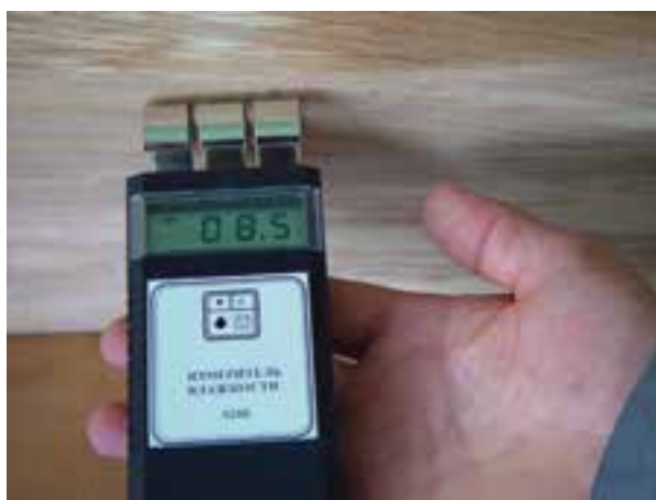
شکل ۱-۱- نوعی رطوبت سنج الکتریکی بدون الکتروود
