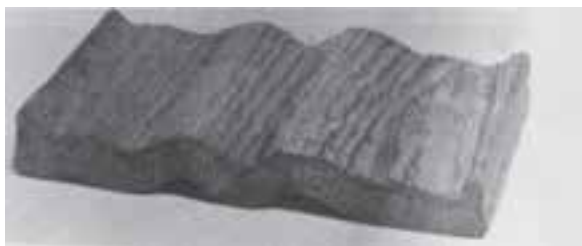
شکل ۱۷-۱ چین خوردگی شدید (موجدار شدن) چوب
