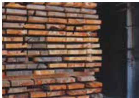
شکل ۱۵-۱ ترک انتهایی در چوب بلوط
