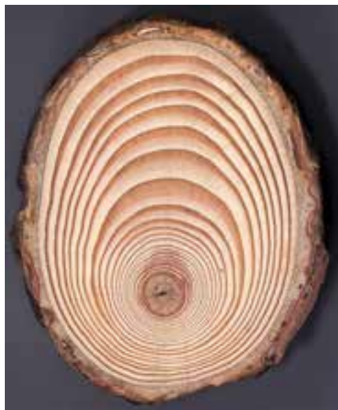
شکل ۷-۱- برش عرضی درخت سوزنی برگ: چوب نرمال در قسمت فوقانی و چوب فشاری در قسمت تحتانی دیده می شود.
