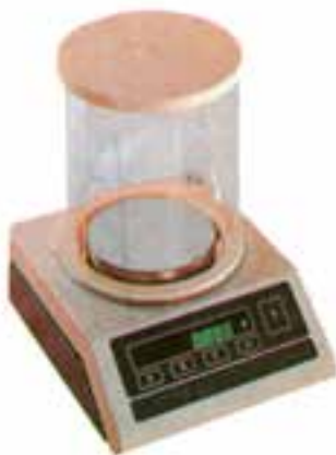
شکل ۳-۳- ترازوی سرپوش دار برای جلوگیری از تبخیر رطوبت
