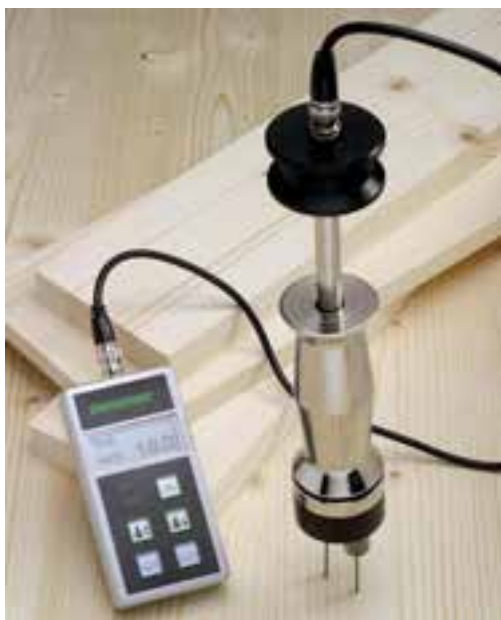
شکل ۳-۶- طرز کار با رطوبت‌سنج الکتریکی
