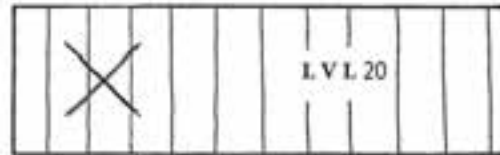
شکل (۲-۲۳) تخته L.V.L با ضخامت ۲۰ میلی متر با علامت سرچوب
