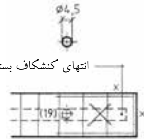
شکل (۲-۴۹) یراق برای آویزان کردن کابینت دیواری با فلز لبه گونیايي و شکاف پیچ نشان داده شده است.
