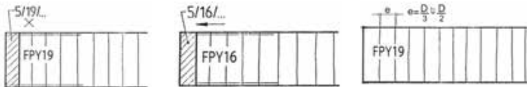
شکل (۹-۲) علائم اختصاری تخته خرده چوب دو طرف روکش شده سرچوب با ضخامت ۱۹ میلی‌متر و زهوار 5 \times 19 میلی‌متر
