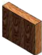
شکل (۲-۱) جهت الیاف چوب بریده شده به صورت طبیعی.
