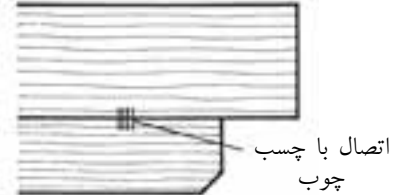
شکل (۲-۲۵) ترسیم هاشور راه چوب ماسیو قطعات به هم چسبیده
