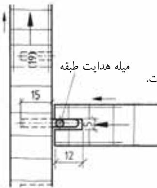
شکل (۲-۵۲) رسم یراق اتصال طبقه کابینت به وسیله زیر سری مفتول زبانه خم در تصویر مجسم و برش پیشانی و برش عمودی کنشکاف وار مفتول در انتهای عرض طبقه بسته است.
