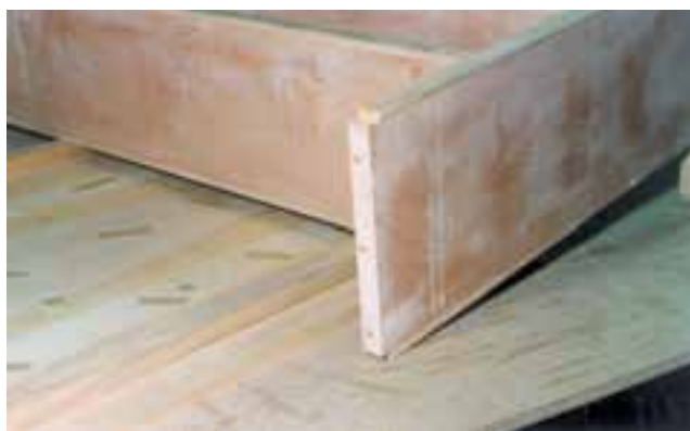
شکل ۱۶- جاسازی دوپل در نر بدنه برای اتصال به کلاف زیر صفحه میز
