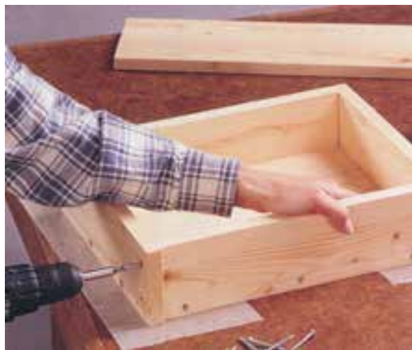
شکل ۲۲- اتصال جعبه با پیچ
