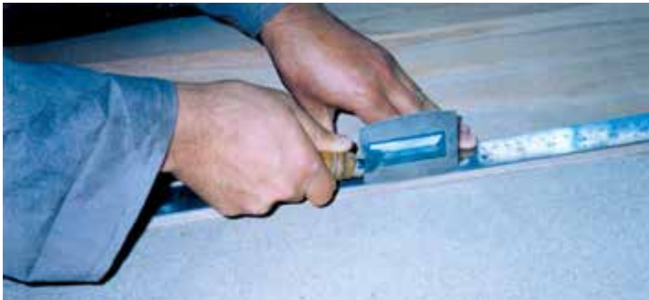
شکل ۱۷- قطع روکش به وسیله‌ی اره‌ی روکش‌بری
