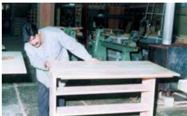
شکل ۱۷- نصب صفحه‌ی میز بر روی بدنه‌ها
