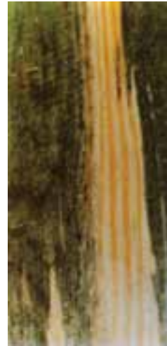
شکل ۸-۵- چوب آلوده به پوسیدگی آبی
