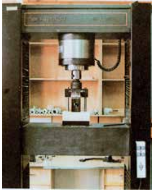
شکل ۶-۹- نحوه اندازه‌گیری مقاومت در برابر فشار عمود بر الیاف چوب
