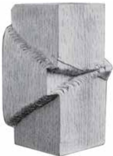
شکل ۹-۱ - شکست چوب در اثر نیروهای فشاری
