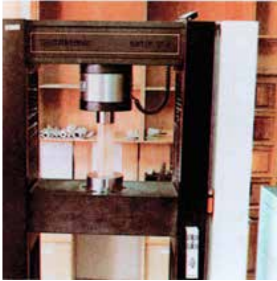
شکل ۳-۹- نحوه بارگذاری برای تعیین مقاومت در برابر فشار موازی با الیاف چوب
