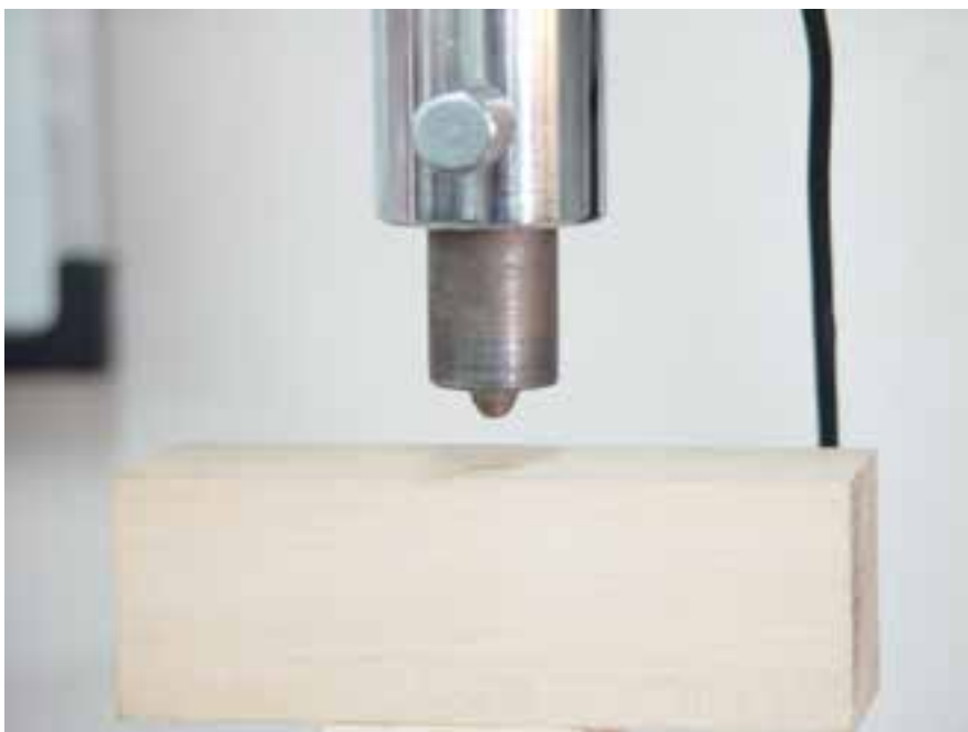
شکل ۱۱-۱- شمای وسیله سنجش سختی چوب
