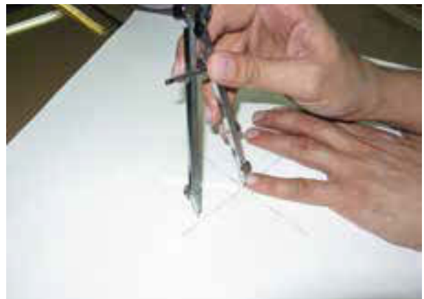
شکل ۳-۴- قرار دادن سوزن در مرکز
