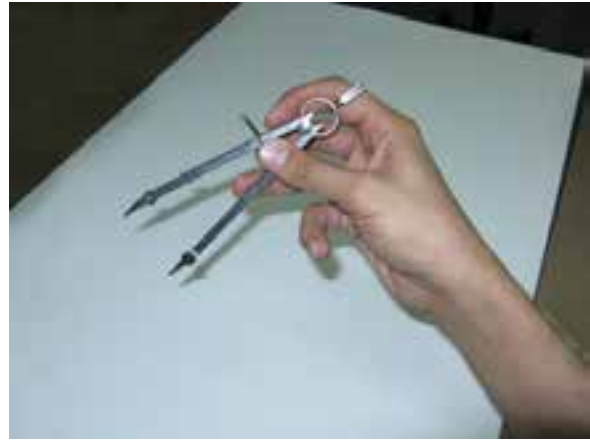
شکل ۲-۴- تنظیم دهانه‌ی پرگار تقسیم
