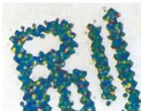
شکل ۶۲-۲- لبه‌های دندان‌دار نمونه‌ی چاپی
