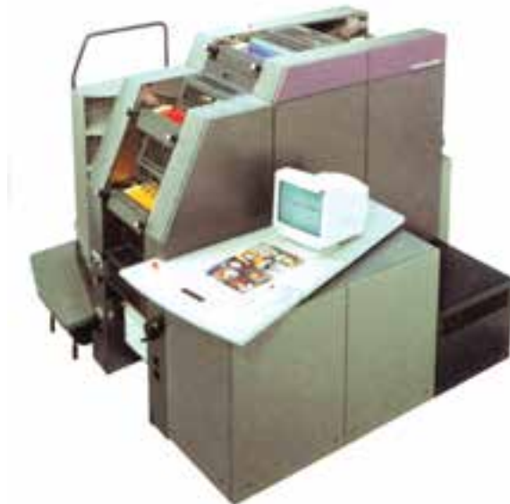
شکل ۲۰-۳ - دستگاه چاپ چهار رنگ DI هایدلبرگ (Heidelberg)
