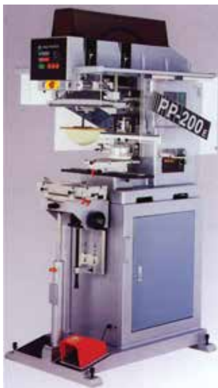
شکل ۳-۱۲- دستگاه چاپ بالشتکی. ۲۰۰ pp. مینوگروپ Mino Group
