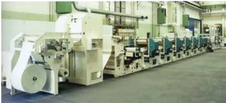
شکل ۱۵-۳- دستگاه چاپ با واحدهای چاپی افست، سیلک و فلکسوی گوبل
