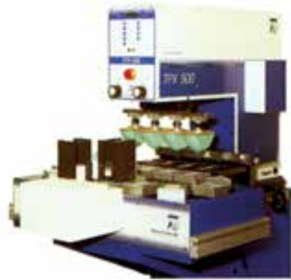
الف) دستگاه چاپ بالشتکی چهار رنگ تکا Teca Print ب) دستگاه چاپ بالشتکی چهار رنگ مورلاک Morlock
