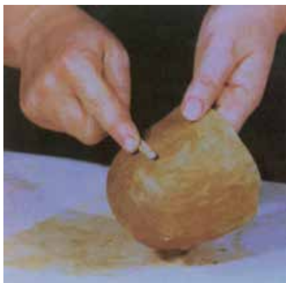
تصویر ۵-ه - پرداختکاری کاسه
