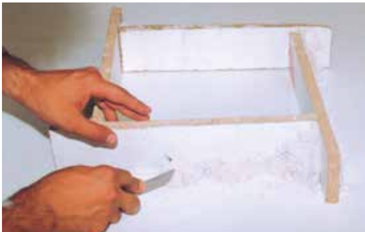
تصویر ۲- ب - بستن درزهای قالب با خمیر گچ
