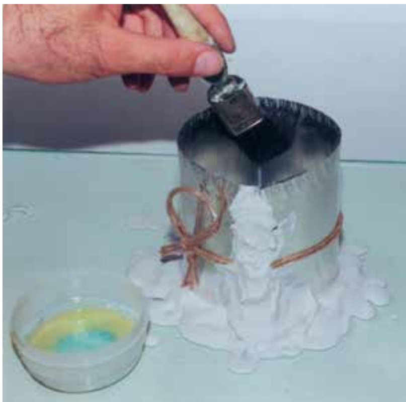
تصویر ۴- چرب کردن دیواره‌های داخل قالب با قلم مو
