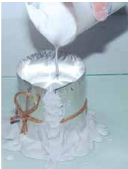
تصویر ۵- ب- ریختن دوغاب گچ آماده شده در قالب
