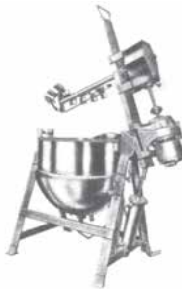
شکل ۱۸-۵- دیگ پخت همزن‌دار در فشار اتمسفر
