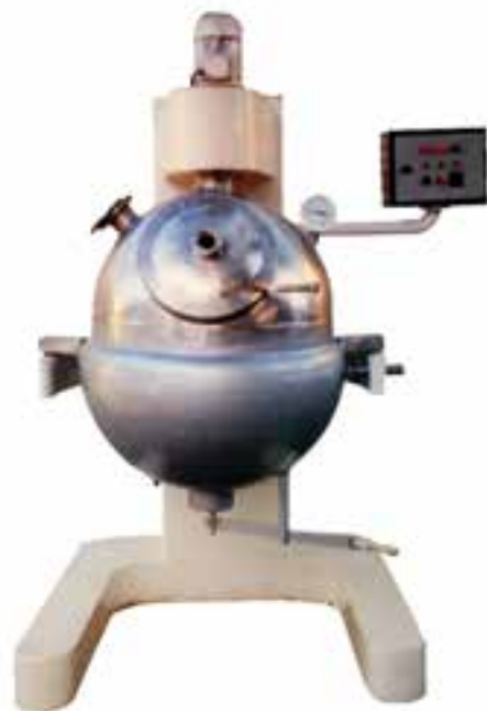
شکل ۱۷-۵- دیگ پخت غیرمداوم در فشار اتمسفر
