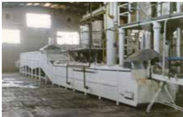
ب - پاستوریزاتور تونلی و نحوه‌ی ورود قوطی‌ها به داخل تونل مشخص شده است.
