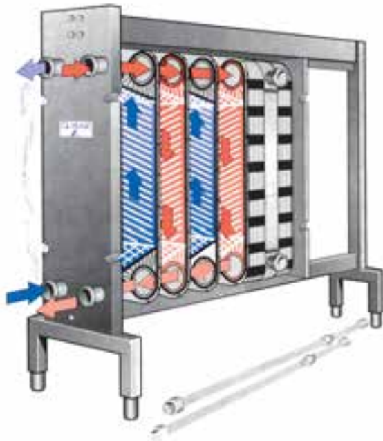
شکل ۵-۵ - جریان‌های اصلی و تبادل حرارت در تبادل‌کننده‌ی حرارتی صفحه‌ای
