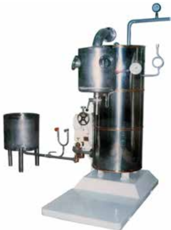
شکل ۱۹-۵- دیگ پخت مداوم در فشار اتمسفر
