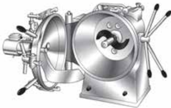
شکل ۴-۶- دیگ بخت باز و یک ور شده برای تخلیه
