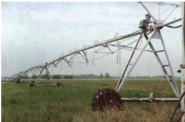
شکل ۹-۲۱- لوله جانبی سیستم سنتریوت
