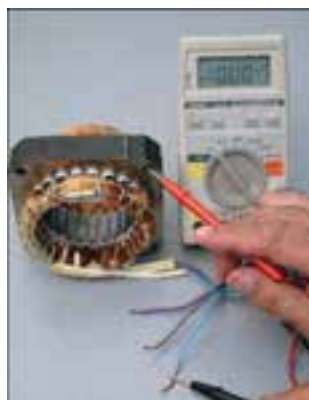
شکل ۱۸-۲ آزمایش اتصال بدنه
