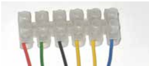
شکل ۲۴-۳ قرار گرفتن سیم‌ها زیر پیچ‌های ترمینال
