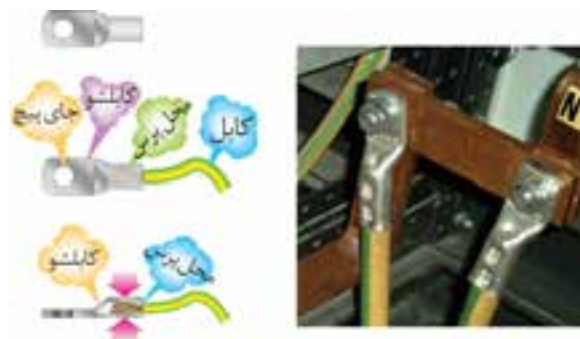
شکل ۳۵-۳ کابل شوی پرس شده
