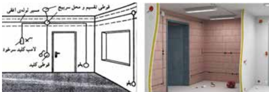
شکل ۶۱-۳ سیم‌کشی با جعبه تقسیم
