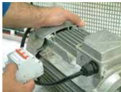
شکل ۸۱-۵ دقت به پلاک موتور هنگام انتخاب فیوز
