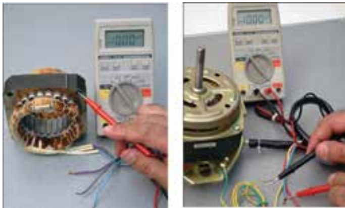
شکل ۵-۷ آزمایش اتصال بدنه
