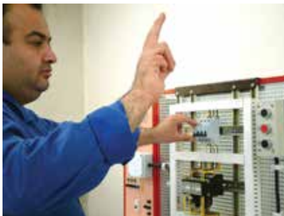
شکل ۵-۶۸ وصل همزمان سه فیوز در مدارات راه‌اندازی موتورهای سه فاز
