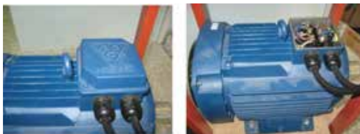
شکل ۵-۱ پلاک اتصالات موتور الکتریکی سه فاز
