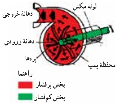
شکل ۱-۲- مسیر حرکت سیال در پمپ گریز از مرکز
