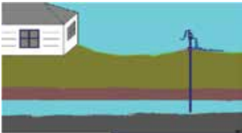
شکل ۸-۱- پمپ آب دستی
