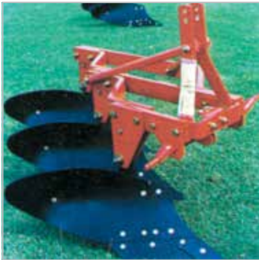
شکل ۱۹-۱- گاو آهن برگردان دار سه خیشه سوار
