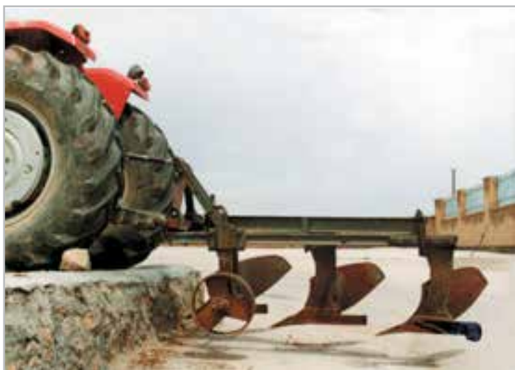
شکل ۲۶-۱- نحوه تنظیم عمق کار گاوآهن
