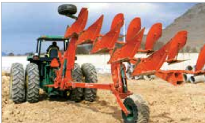
شکل ۱-۱- گاواهن دوطرفه در وضعیت حمل
