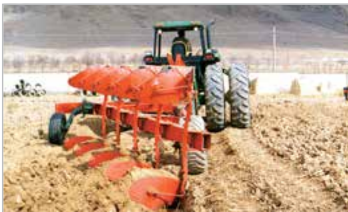
شکل ۱-۲- گاو آهن دو طرفه در حالت کار
