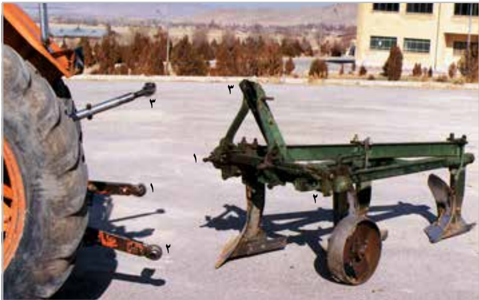
شکل ۲۰-۱- نقاط سه گانه اتصال گاوآهن و تراکتور
