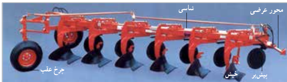
شکل ۱-۳- گاو آهن نیمه سوار شش خیشه
