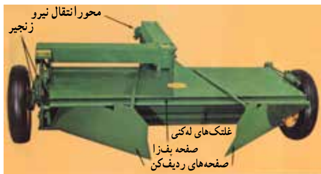
شکل ۱-۵- نمای عقب ساقه‌کوب کششی
