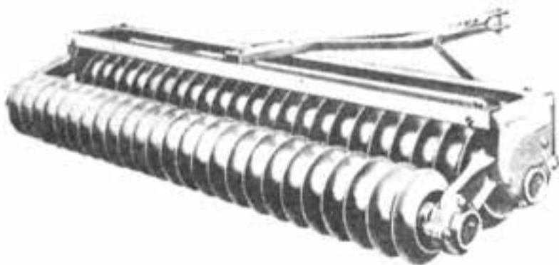
شکل ۲۱-۲ - غلتک شیاردار با دو ردیف حلقه های لبه ۷ شکل
