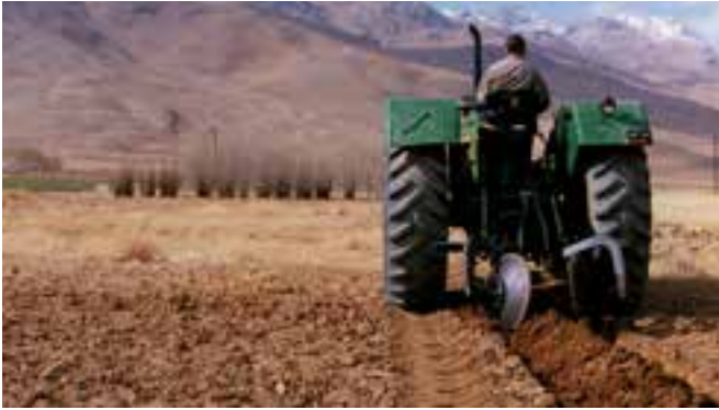
شکل ۳-۳- مرکزکش بشقابی در حین عملیات مرکزکشی
