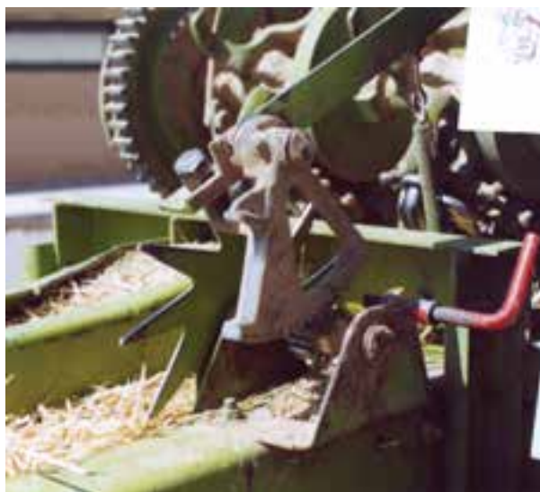
شکل ۱۲-۶- اجزای تنظیم طول بسته علوفه در بسته‌بند مکعبی
