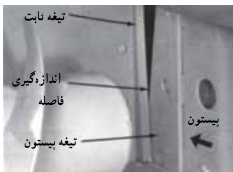
شکل ۱۱-۶- موقعیت و فاصله صحیح تیغه‌ها در بسته‌بند مکعبی
