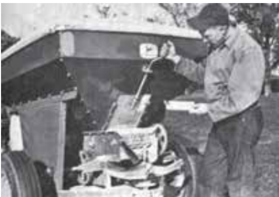
شکل ۷-۵ — اهرم کنترل دریچه
