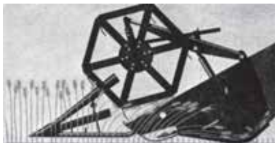
شکل ۲۰-۸- نحوه کار چرخ فلک کمباین غلات به هنگام برداشت.
