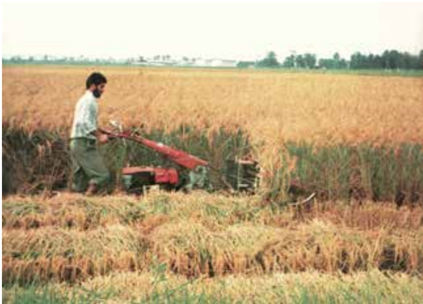
شکل ۲-۸ — دستگاه درو ردیف‌کن در حال برداشت برنج
