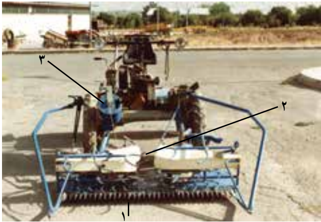
۱- شانه برش ۲- دهانه دسته‌بند ۳- محافظه محتوی دوک نخ شکل ۸-۸- واحد درو دسته‌بند و اجزای آن
