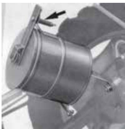
شکل ۱۱-۸- محفظه دوک نخ، درپوش و پیچ و فنر تنظیم کشش نخ
