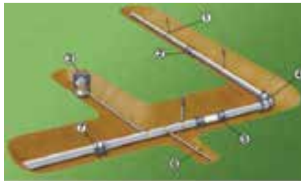
۱- رایزر ۲، ۴، ۵ و ۷ اتصالات ۳- آب پاش مخفی شونده
