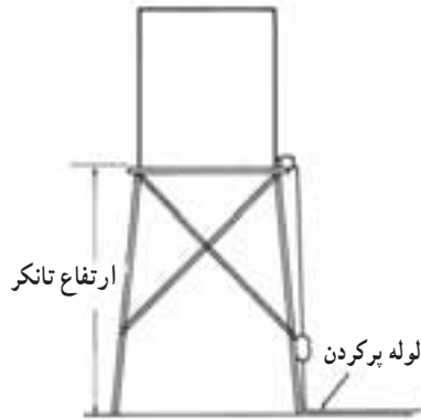
الف) شماتیک تانکر هوایی و لوله پر کردن
