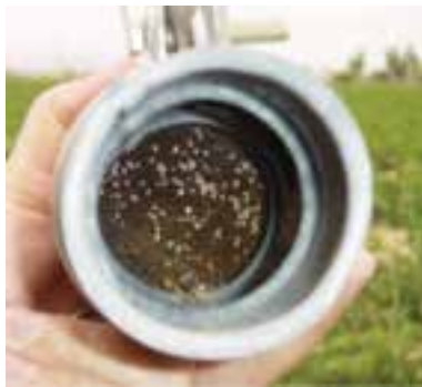
شکل ۱۸-۷- صافی (فیلتر) در مسیر لوله نیمه اصلی
