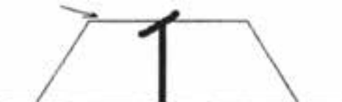
ج) الگوی پاشش دوزنقه آب پاش با نصب پره یا میخ
