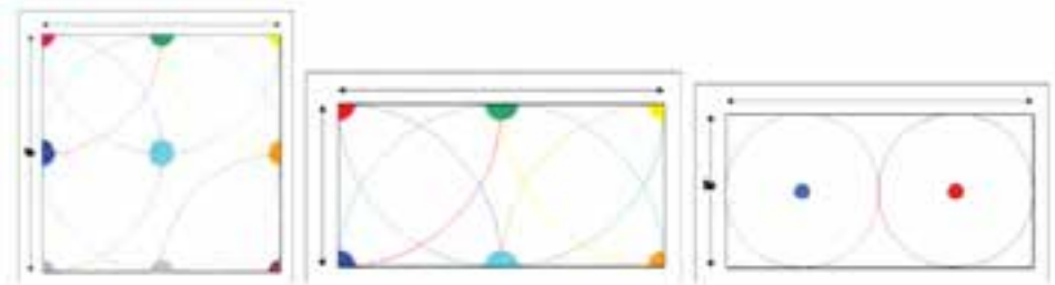
الف) سطح آب پاشی دو آب پاش بدون هم پوشانی
