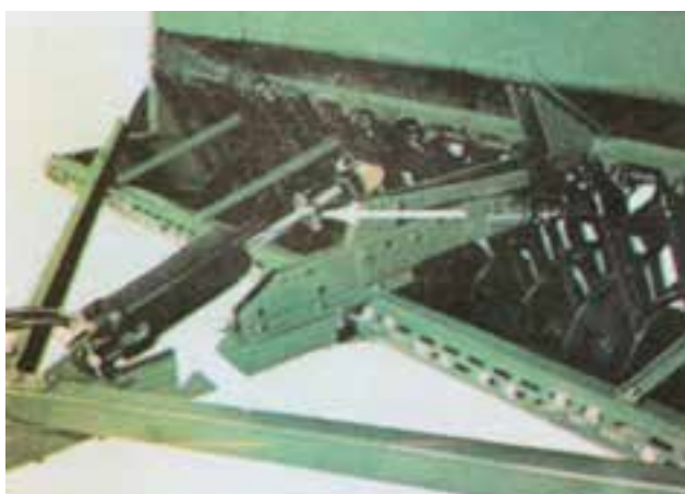
شکل ۱۵-۶- تنظیم عمق کاشت توسط جک هیدرولیک
