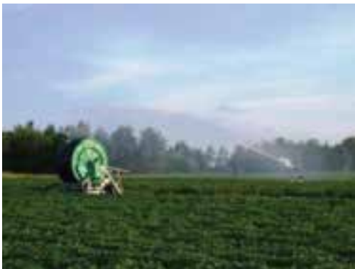
ب) ارابه در حین آب‌پاشی به سمت قرقره کشیده می‌شود
