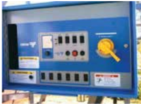
شکل ۷۱-۷- تابلو کنترل دستگاه سنتریوت
