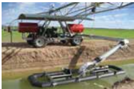
ب) قرار دادن لوله ورودی در کانال آبرسانی
