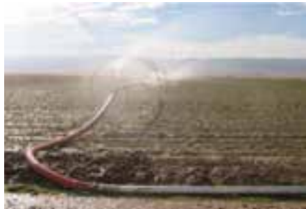
شکل ۵۷-۷- اتصال شیر هیدرانت به دستگاه ویلمو با شیلنگ
