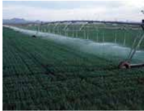
الف) آرایش آب‌پاش‌ها روی لاترال‌ها
