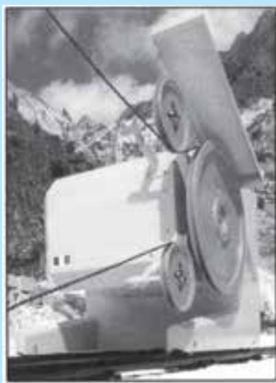
دستگاه برش سنگ با سیم الماسه
