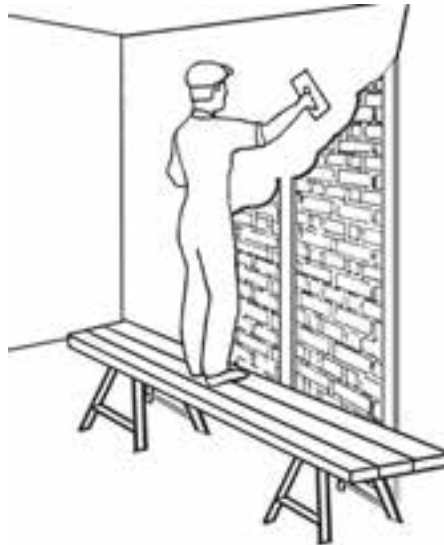
شکل ۵-۸- طریقه‌ی گچ کاری دیوار
