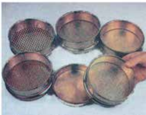
شکل ۲-۱۱- شیکر (Shaker) برای سرنند کردن دانه‌ها (تصویر سمت راست) انواع الک با شماره‌های مختلف (تصویر سمت چپ)
