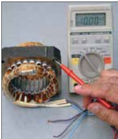
▲ شکل ۱۴-۲- تست اتصال بدنه
