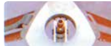
شکل b-۸-۱۲- پیچ روی سه پایه
