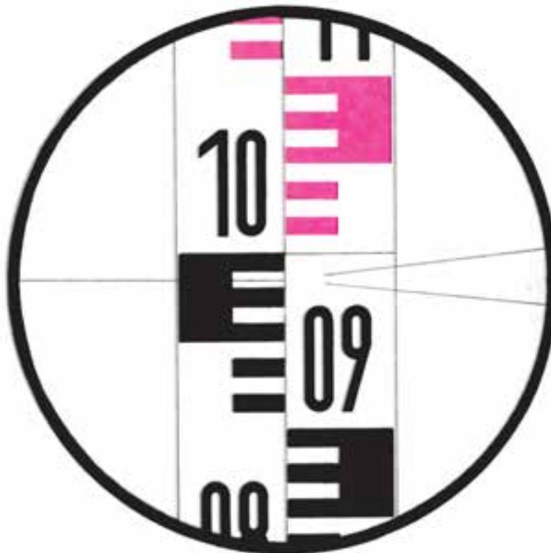
شکل ۸-۳۳- قرائت روی میر
