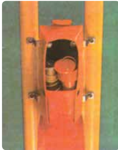
شکل ۳۱-۸- شاقول مخصوص نقشه برداری
