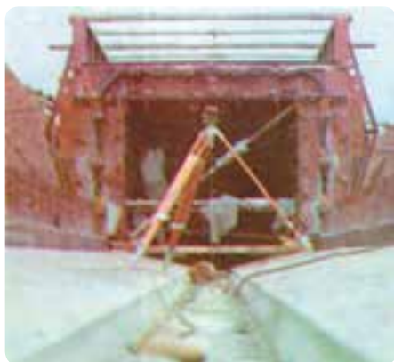
شکل ۳۰-۸- دوربین تراز یاب، سانتراژ با شاقول
