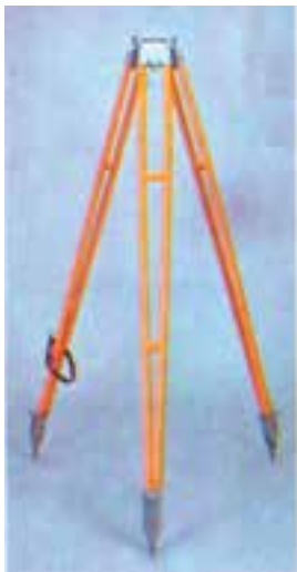
شکل ۸-۱۲- چند نمونه سه پایه تراز یاب
