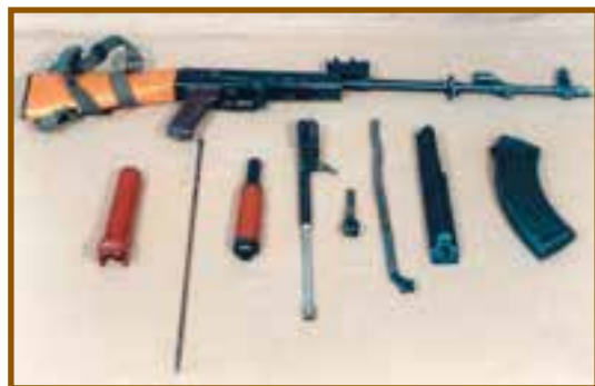
شکل ۳ - نمای باز شده سلاح کلاشینکف
